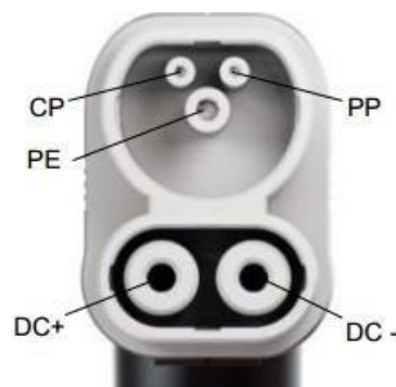
Figura 1 Diagrama del conector de carga
